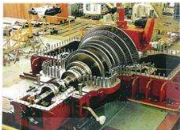
・蒸気タービン
