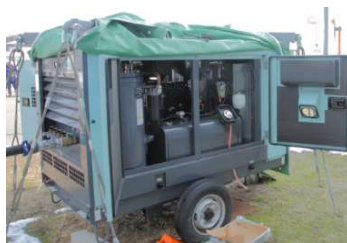
可搬型空気圧縮機
