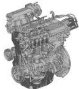
ガソリンエンジン （Otto cycle, 1876） 【実運転で十数%、 最近は効率アップ、 水素エンジンも】
