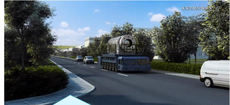
ガラス固化体を入れた専用容器（総重量100トン規模）を運ぶトレーラーが走る道路を整備
